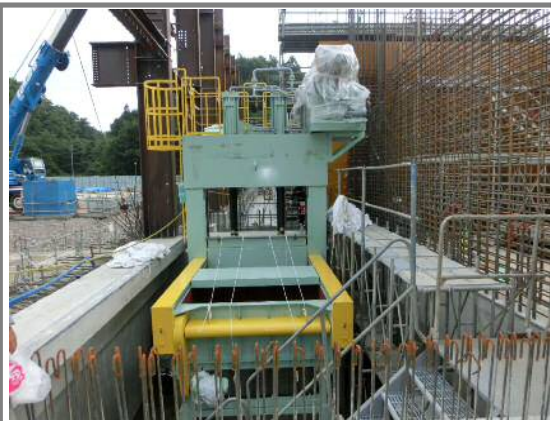
● 可燃性粗大ごみ切断機【8月29日撮影】 搬入された可燃性粗大ごみ（木製家具、畳等）を処理可能な大きさに切断します。
